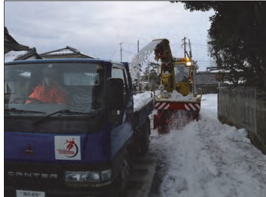
歩道の除雪作業 (坂井町)
