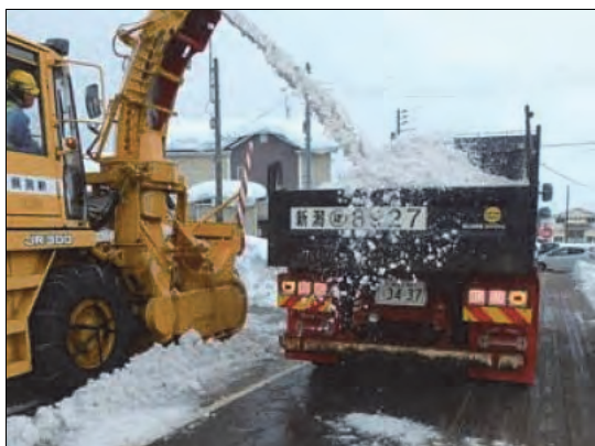
ロータリーによる除排雪作業
