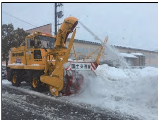
路肩での除排雪
