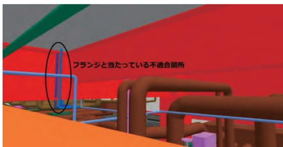
鉄骨と設備配管の干渉検討
