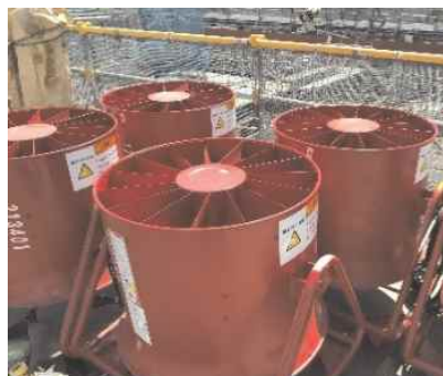
送風機により通気性を確保するとともに、ドライミスト発生装置等も併用
