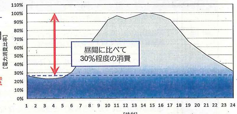
図2：平均的なオフィスビルにおける電力需要カーブのイメージ
