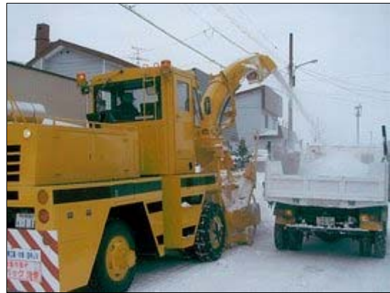
ロータリー除雪車と小型ダンプによる排雪
