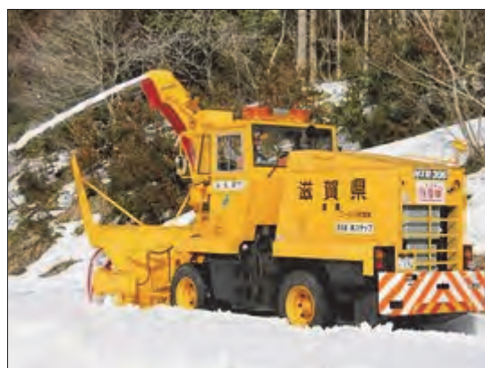
ロータリー除雪車による除雪作業
