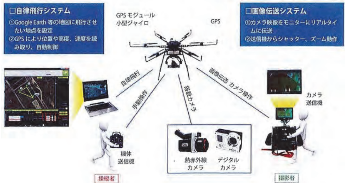
ドローンによる法面調査システムの構成
