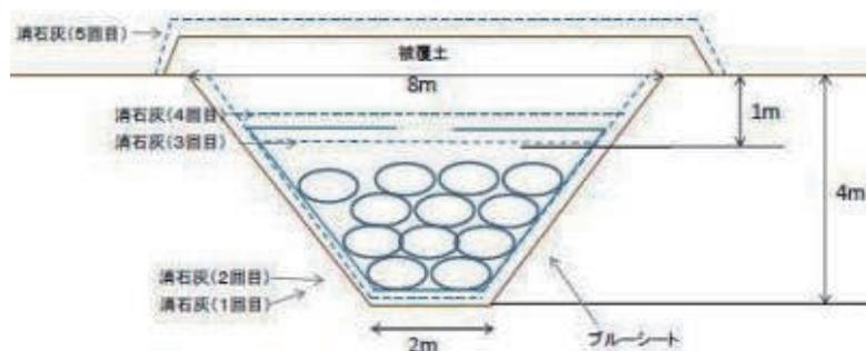
埋却溝の断面図
