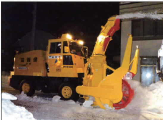
除雪運搬作業
