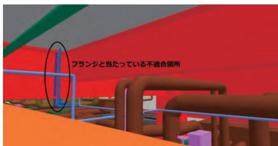
鉄骨と設備配管の干渉検討
